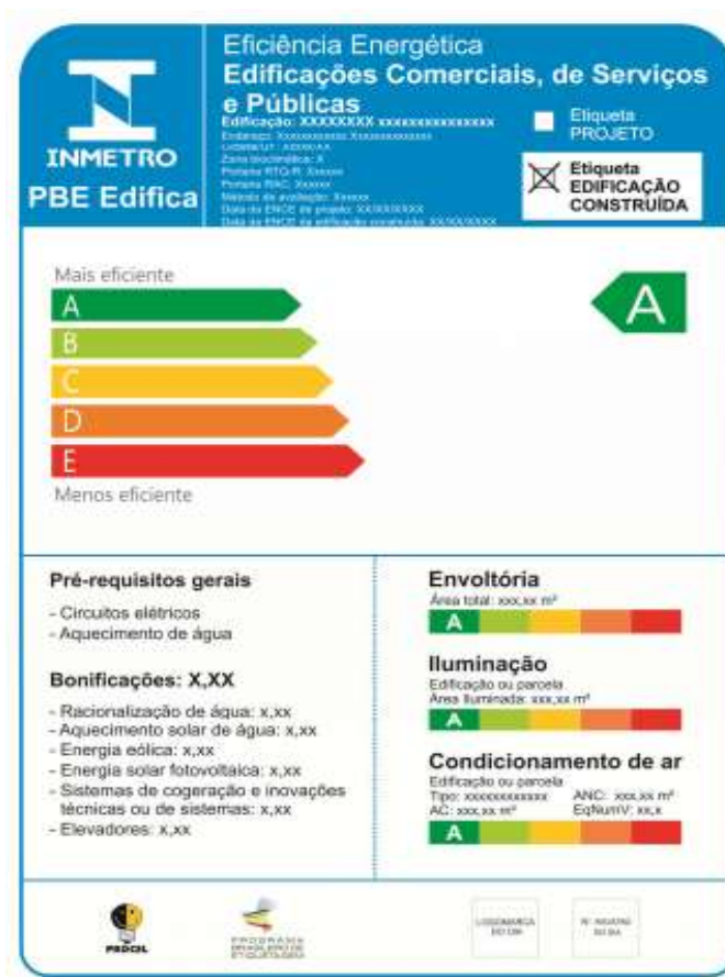
Figura 13 – Exemplo de Etiqueta Nacional de Conservação de Energia – ENCE de Edificações Comerciais, de Serviços e Públicas.
