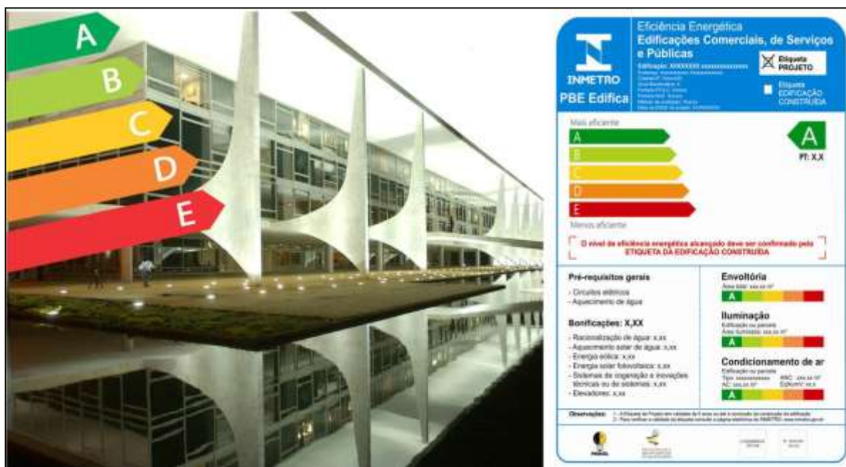
Figura 5 – Exemplo de Etiqueta do PBE- Edifica: Edificações Comerciais, de Serviços e Públicas.
